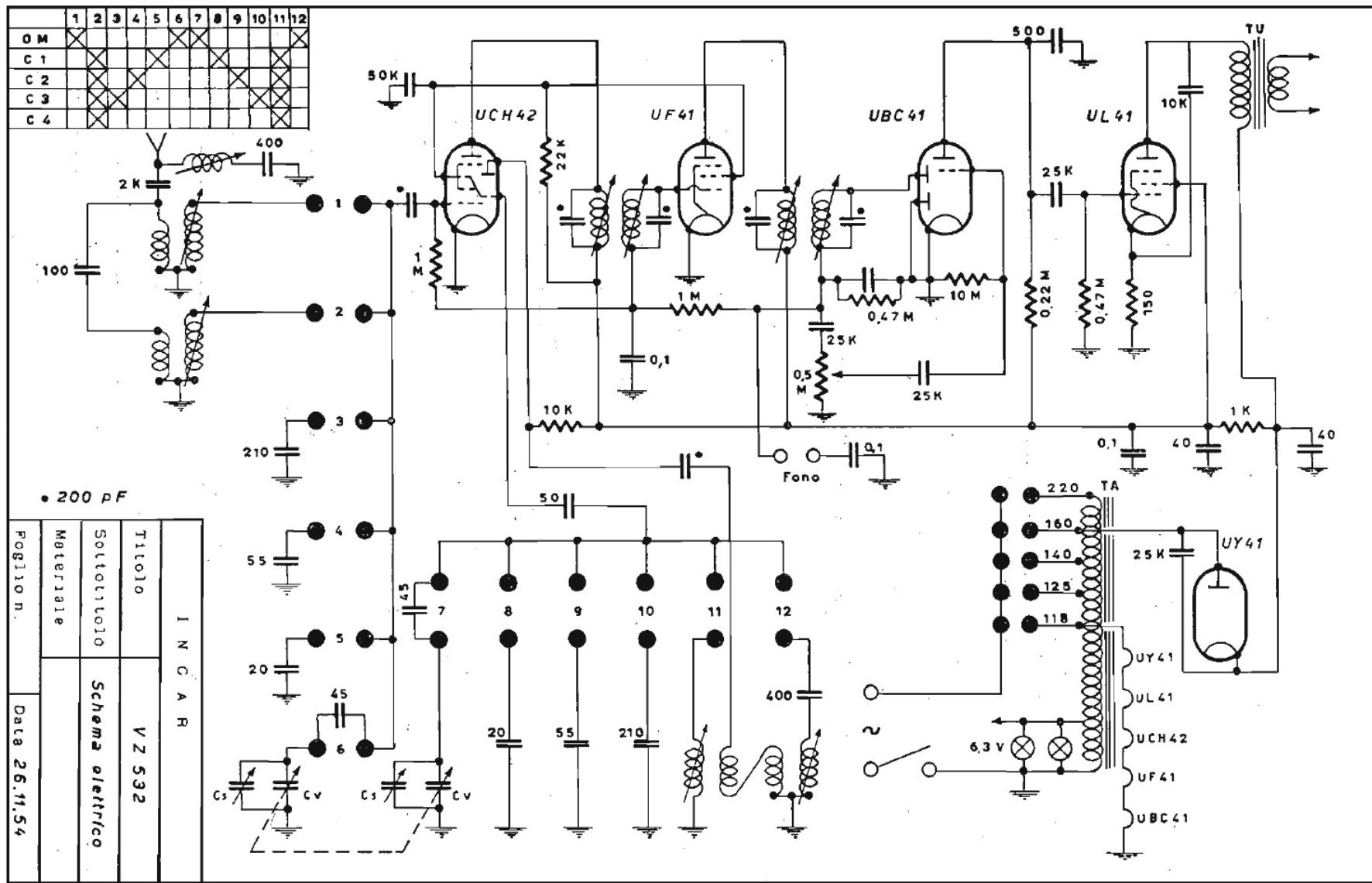
INCAR - Mod. VZ 532 - Ricevitore a onde medie con quattro bande allargate in onde corte. Potenza d'uscita 3 watt. Consumo 50 watt.
